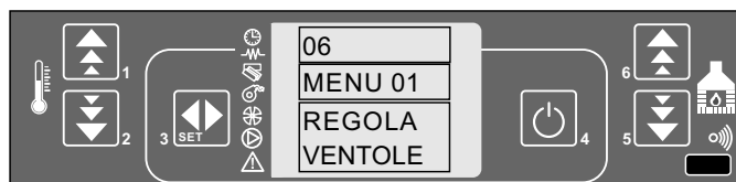
pannello comandi - regolazione canalizzazione
