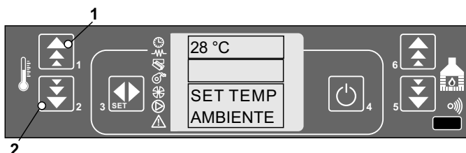
pannello comandi - modifica temperatura ambiente
