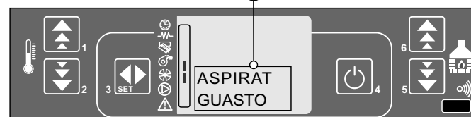
pannello comandi - display di stato del prodotto
